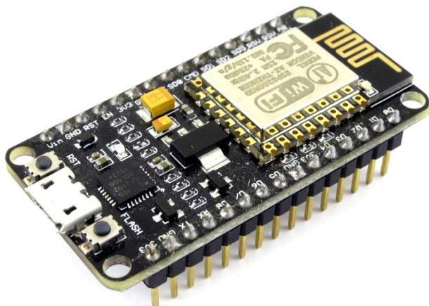
Рис. 2.7. Плата NodeMCU
